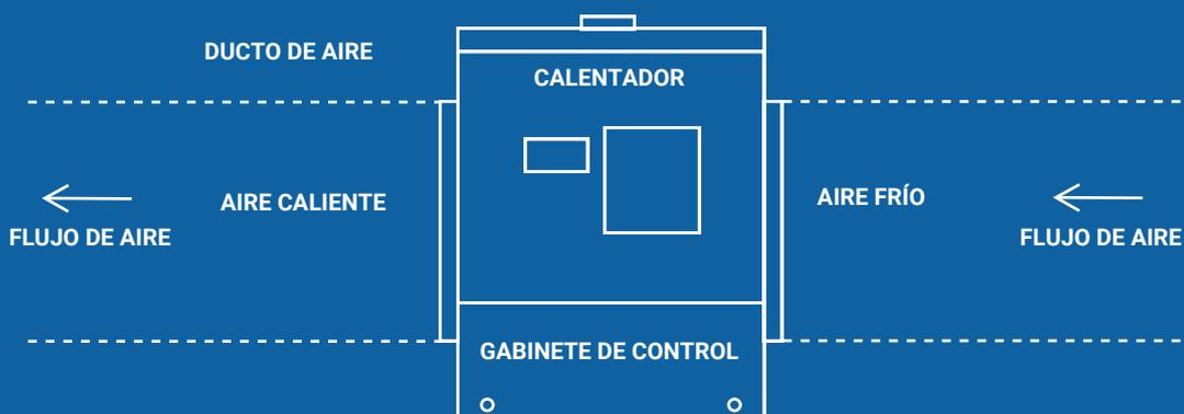
NO instalar en donde exista ambientes potencialmente explosivos ya que la unidad trabaja con GAS. Debe ser instalado en el sentido del flujo indicado. Presión de gas para operación GAS NATURAL: 4-6 onzas/pulg2 GAS LP (BUTANO): 5-9 onzas/pulg2. Es importante la ubicación del calentador a gas ya que requiere oxígeno para trabajar (si trabaja dentro de un cuarto de maquinas es necesario que este ventilado). Realizar ajustes necesarios en base a la A.S.N.M. (Altitud sobre el nivel del mar).
